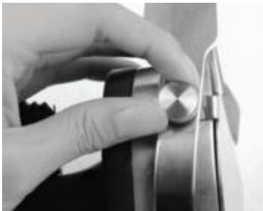
1. Odemontujte blokovací šroub a regulační kroužek
