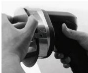
5. Namontujte kryt nože, regulační kroužek a blokovací šroub
